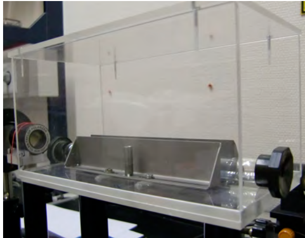
Abbildung 6: Dargestellt ist die Rohrküvette mit den passenden Kondensatorplatten und dem Schutzdeckel.
