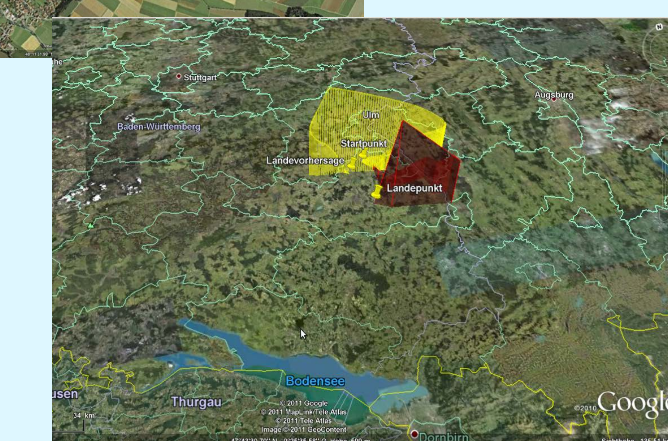
vorhergesagte Flugbahnen mit Höhenprofil (gelb) und aus den Messdaten und Videos abgeschätzte Flugbahn
